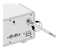
► Schrauben Sie die Antenne an.
