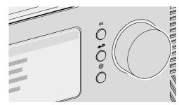
Die Steuerung und Bedienung des Geräts erfolgt über die Navigationstasten und den Drehregler (z. B. um Menüpunkte auszuwählen oder den Anweisungen auf dem Display zu folgen).
