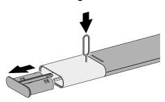
▶ Öffnen Sie das Batteriefach.
