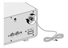
► Schrauben Sie die Antenne an.
