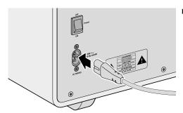
▶ Stecken Sie das Stromkabel in das Gerät.
