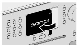
► Entfernen Sie die Schutzfolie vom Display.
