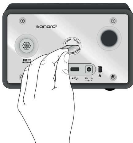
Fig. 8: Inserimento della batteria
